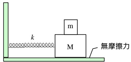
解：接近滑動的邊沿，就是作用於小方塊上的力（在那點應為最大的加速度）為  $f_{max} = \mu mg$ 。在那一小方塊上的加速度為  $a_{max} = \omega^2 x_{max}$ ，其  $\omega$  為角頻率 ( $\omega = \sqrt{k/(m+M)}$ )。故此，用牛頓第二定律，我們得
